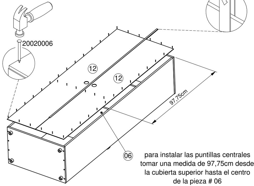
para instalar las puntillas centrales tomar una medida de 97,75cm desde la cubierta superior hasta el centro de la pieza # 06
